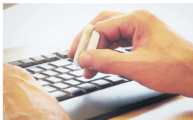
De bewegingssensor in de Mycestro voelt de richting van de zwaartekracht en detecteert snelheidsveranderingen.
